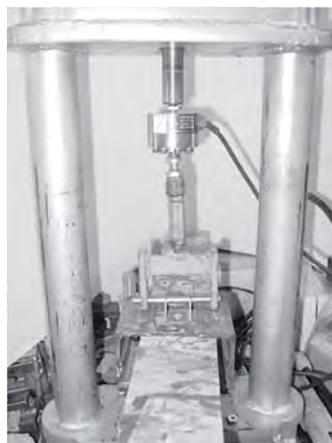
▲IC野地板用ビス引抜き強度試験
